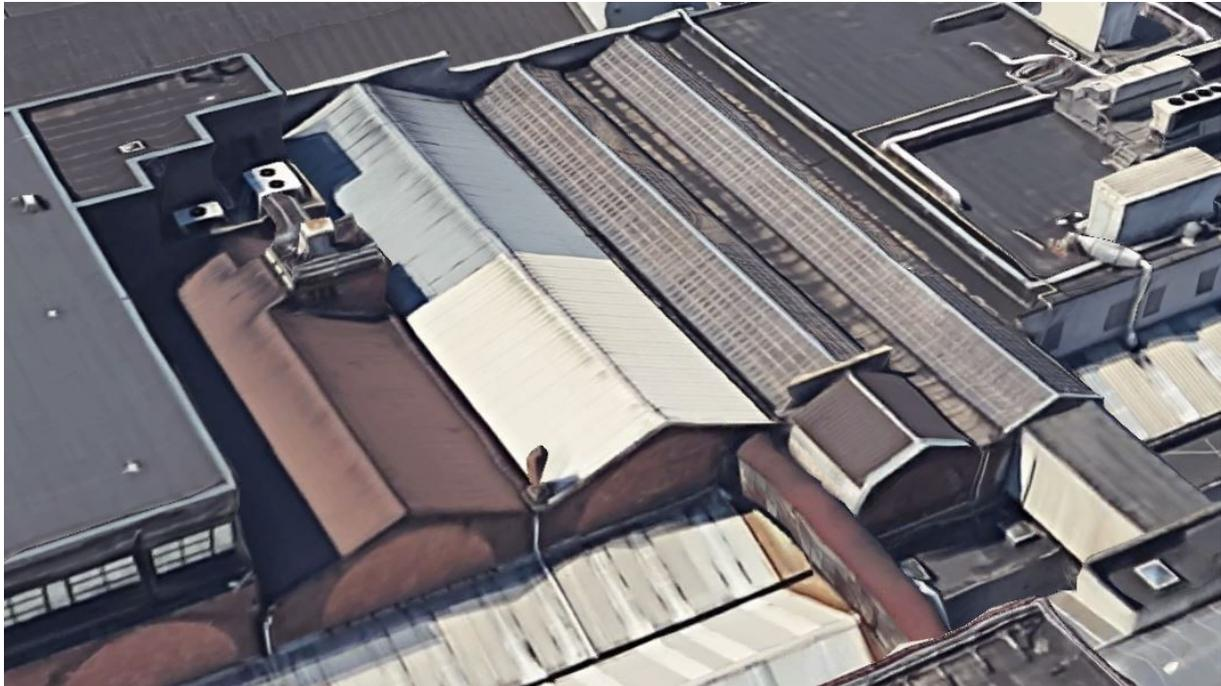
*Vue cavalière des halles de 1905 (longue et fine, à droite) et 1907 (plus large, à gauche) insérées dans le bâti moderne de Delhaize (en bas, la toiture de la rue couverte). Les verrières semi-circulaires ont été comblées de briques. Ces quatre magasins ont conservé la structure originale de leurs toitures. Source : Google Maps.*
