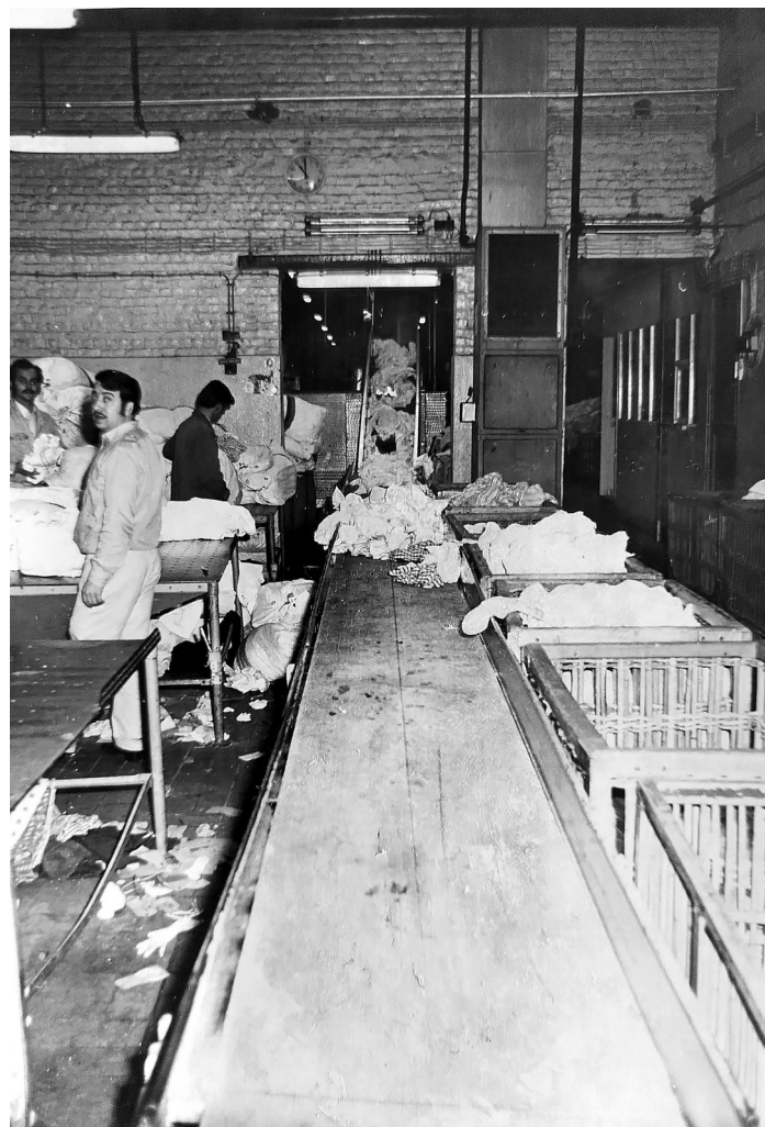
Au sein de l'ancienne halle de 1902, vers la rue du Cerf, salle de triage du linge sale et son tapis roulant conduisant au hall de lessivage/essorage. ACP SB, Fonds Iconographique, Expo 1975, Images 1 à 17.
