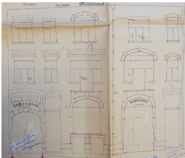
Figure 4: Façade des anciennes maisons des numéros 75 à 81 rue de Liverpool, adaptées aux besoins de Sobecommin (modification des baies au r-d-c), avant transformation en 1960. ACA TP. 40.221.
